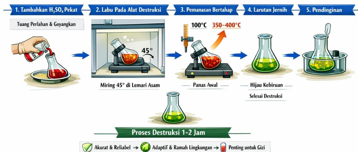
Gambar 7. Tahap Destruksi (Mineralisasi) Metode Kjeldahl. Gambar ini menjelaskan proses destruksi sampel dalam analisis nitrogen menggunakan metode Kjeldahl. Sampel dimasukkan ke dalam labu Kjeldahl, kemudian ditambahkan asam sulfat pekat (H 2 SO 4 ) bersama katalis seperti selenium, tembaga sulfat, dan kalium sulfat. Labu dipanaskan secara bertahap mulai dari suhu rendah hingga mencapai 350–400°C, sehingga protein terurai menjadi amonium sulfat ((NH 4 ) 2 SO 4 ), sementara karbon dan
