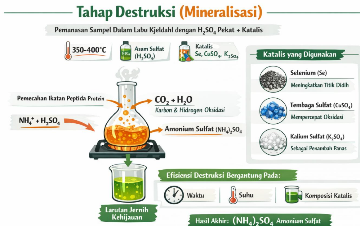
Gambar 1. Tahap Destruksi (Mineralisasi) Metode Kjeldahl. Gambar ini menggambarkan proses destruksi dalam analisis nitrogen menggunakan metode Kjeldahl. Sampel dipanaskan dalam labu Kjeldahl dengan asam sulfat pekat ( \text{H}_2\text{SO}_4 ) dan campuran katalis seperti selenium (Se), tembaga sulfat ( \text{CuSO}_4 ), serta kalium sulfat ( \text{K}_2\text{SO}_4 ). Pada suhu tinggi (350–400°C), ikatan peptida dalam protein terurai, karbon dan hidrogen teroksidasi menjadi \text{CO}_2 dan \text{H}_2\text{O} , sementara nitrogen bereaksi membentuk amonium sulfat ( (\text{NH}_4)_2\text{SO}_4 ). Efisiensi destruksi sangat dipengaruhi oleh suhu, waktu pemanasan, dan komposisi katalis. Larutan akhir yang jernih kehijauan menandakan proses mineralisasi telah sempurna dan siap untuk tahap destilasi berikutnya.
